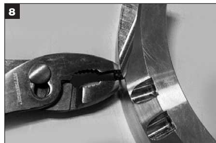
8 Die Zentrierknöpfe (6x) aus dem Außendurchmesser des Gegenringhalters ausbauen.
